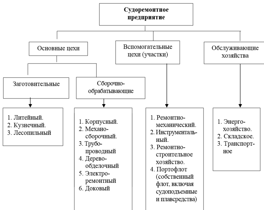
Рис. 5. Типовая производственная структура судоремонтного предприятия
