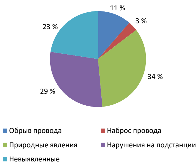
Рис. 2. Диаграмма распределения технологических нарушений в электросети 35 кВ Fig. 2. Distribution diagram of technological violations in the 35 kV power supply network
