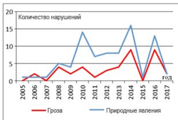
Рис. 4. Зависимость технологических нарушений на ВЛ 35 кВ от природных явлений
