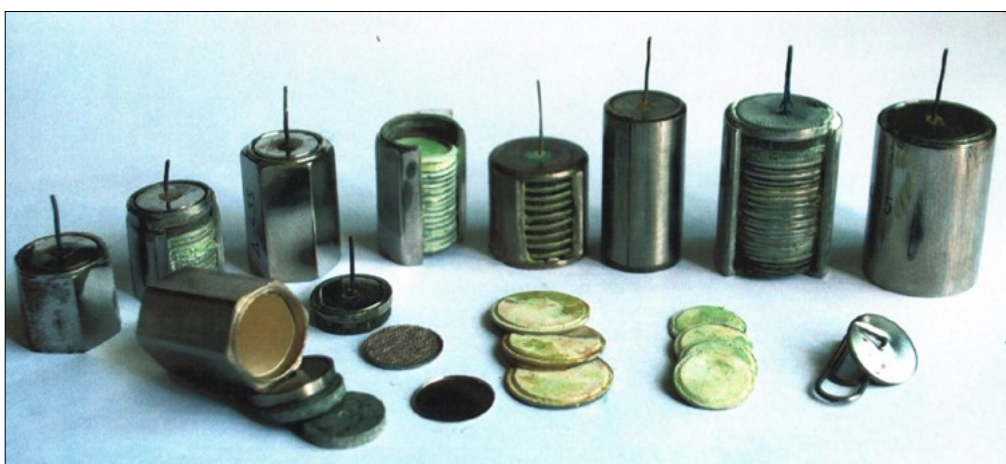
Рис. 2. Внешний вид элементов, деталей и источников тока на основе \text{RbAg}_4\text{I}_5 (разработка НПО «Квант»)
