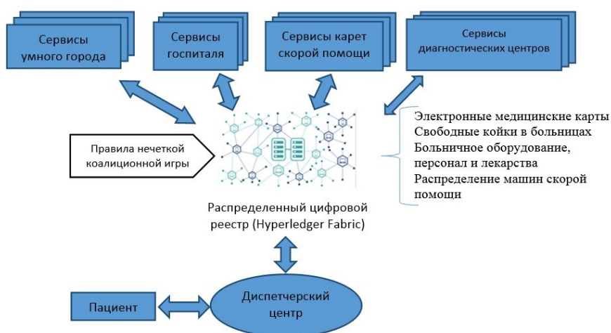
Рис. 4. Взаимодействие сервисов в процессе принятия решений в нечеткой коалиционной игре с использованием смарт-контрактов
