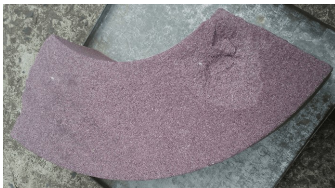
Рис. 2. Образец абразивного кольца из хромотитанистого электрокорунда Fig. 2. Sample of a vitrified grinding wheel made of pink fused alumina with titanium dioxide
