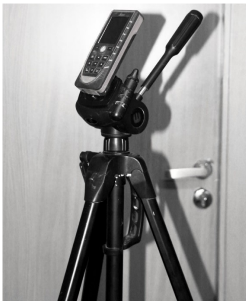
Рис. 19. Крепление лазерной рулетки к треноге
