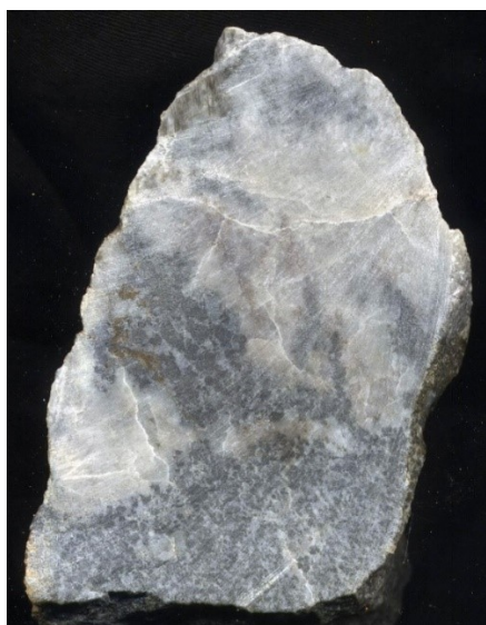
Рис. 5. Критический горизонт Йоко-Довыренского интрузива. Ручей Центральный. Магматические брекчии – обломки троктолитов и оливиновых габбро-норитов сцементированы сульфидоносными анортозитами. Слева - 100x55 мм. Справа – 108x88 мм. Фото Э.М. Спиридонова.
