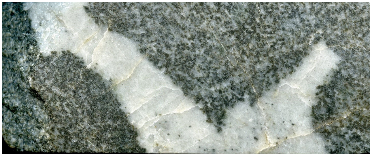
Рис. 1. Йоко-Довыренский интрузив. Центральный ручей. Жилы анортозитов в троктолитах. У контактов анортозиты мелкокристаллические, в центре внедрений – среднезернистые с редкими более крупными ксеноморфными авгитом и бронзитом. 101х41 мм. Колл. Г.С. Николаева. Фото Э.М. Спиридонова.
