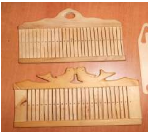
Рис. 11. Бердо – приспособление для ручного ткачества (из личного архива информанта)
