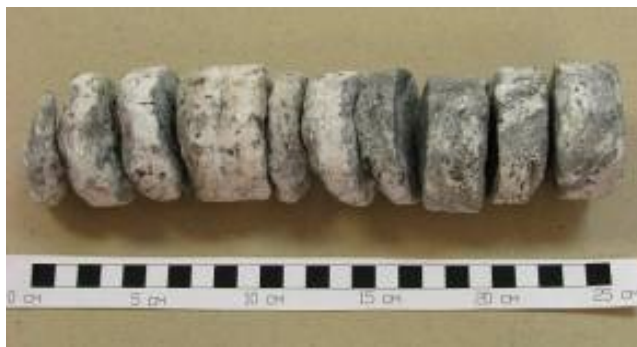
Рис. 6.61. Дискование керна в карбонатите (рудник «Железный»)
