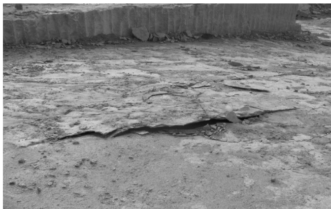
Рис. 2.26. Вид отслаивающихся породных пластин в дне карьера
