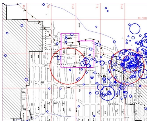
Рис. 5.87. Горнотехническая ситуация на конец февраля 2015 г. и сейсмические события, зарегистрированные в марте 2015 г.
