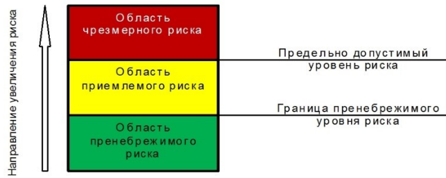
Рис. 6.1. Разбиение диапазона значений индивидуального риска на три области: недопустимого (чрезмерного), приемлемого и пренебрежимого
