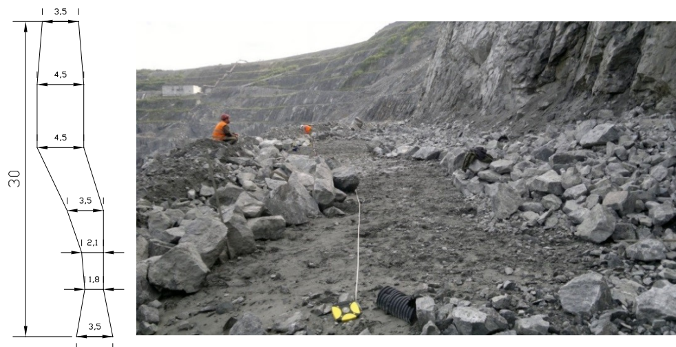
Рис. 1.17. Общий вид и геометрия площадки проведения георадарного обследования
