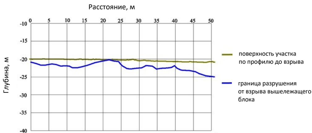
Рис. 3.14. Разрез уступа по профилю георадарного зондирования исследуемого участка уступа до МВ с нанесенной границей разрушения от взрыва вышележащего блока
