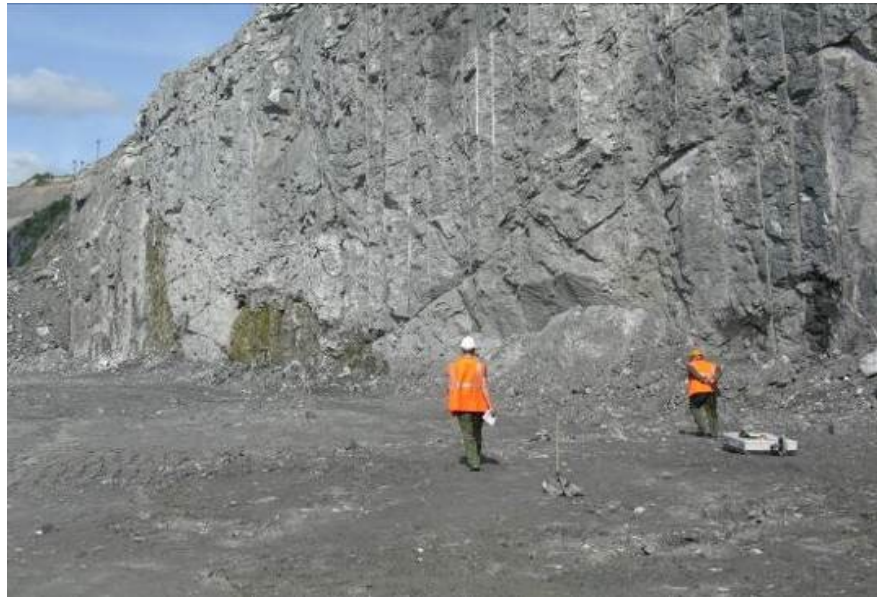
Рис. 1.15. Экспериментальные исследования участка уступа гор. +40 м георадарным комплексом RAMAC/GPR X3M
