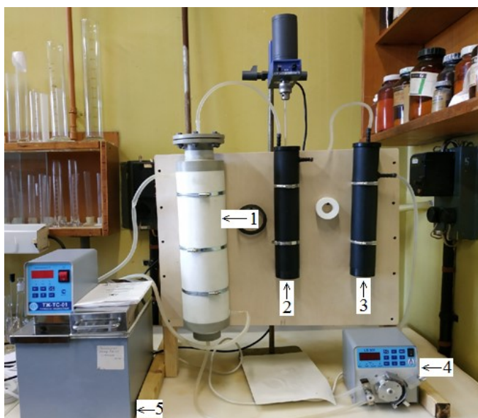
Рис. 4. Принципиальная схема и общий вид укрупнённой лабораторной установки для сорбционной конверсии
